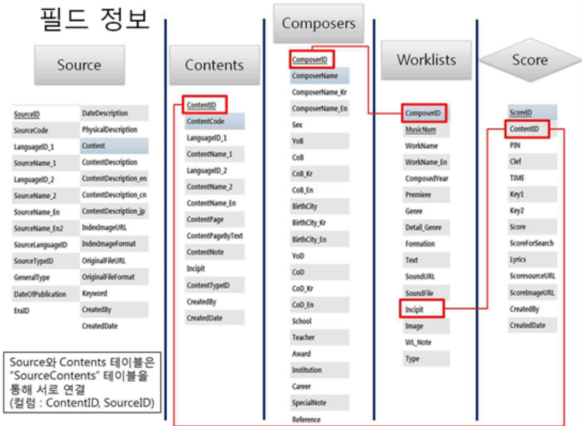
(그림 36) 확장 신규 구축된 DB 테이블의 필드 정보 및 상호 연결도를 통한 검색
